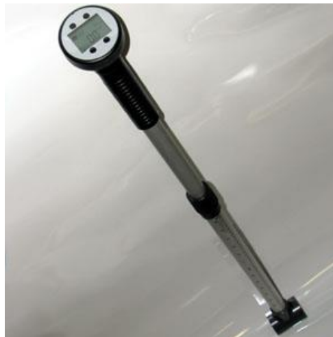
Figura 3-4: Instrumento utilizado para el aforo: correntómetro FP111.
